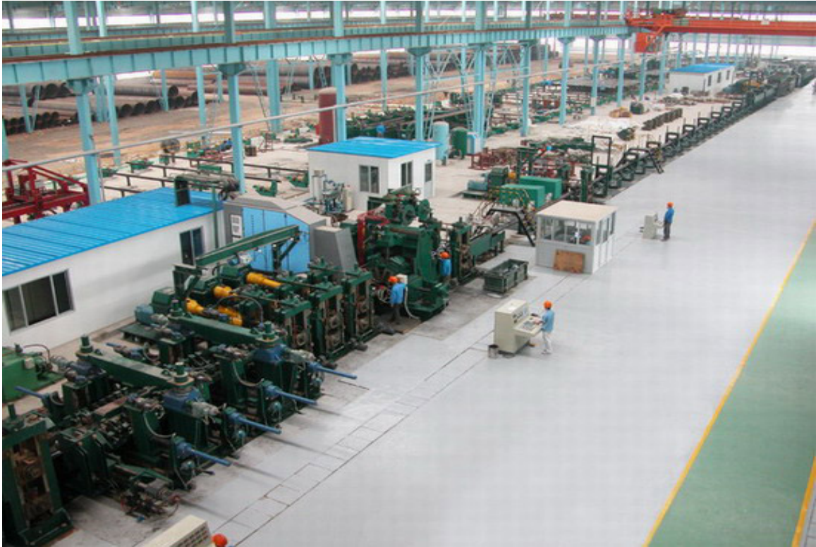
Dây chuyền máy làm ống đen(ảnh chụp)
