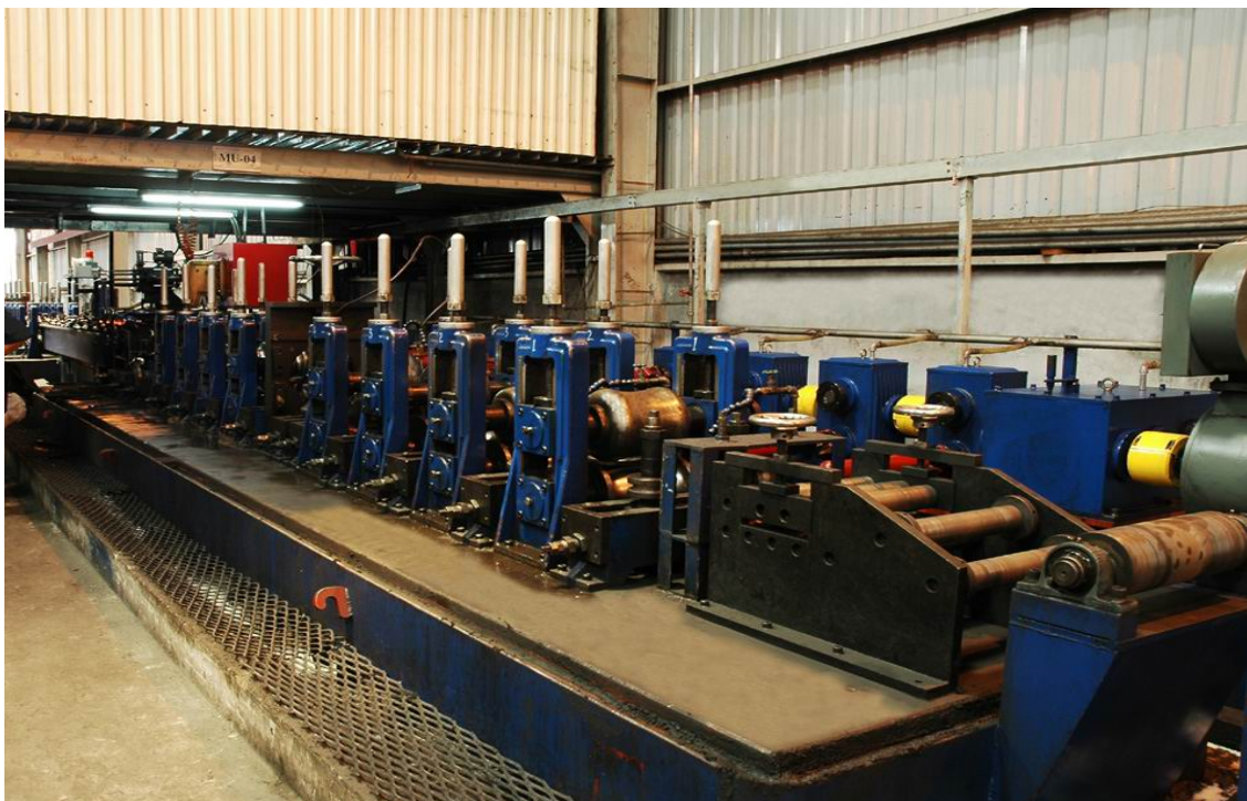
Dây chuyền máy làm ống đen (ảnh chụp)
